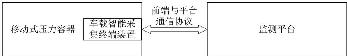
图 1 移动式压力容器动态监测系统总体结构
