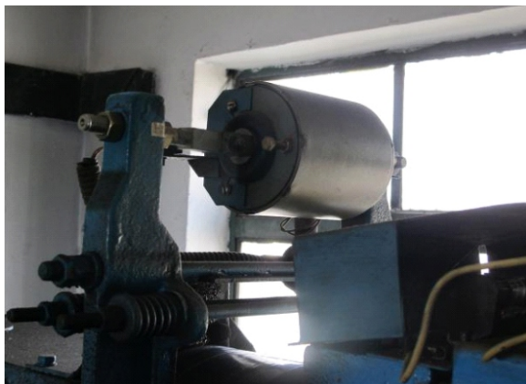
图24 未调整好的E型制动器
