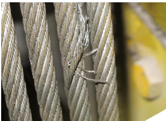
图15 存在断股现象的钢丝绳
