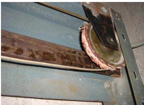
图10 滚轮老化、磨损严重
