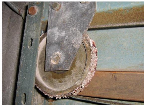
图11 滚轮老化、磨损严重
