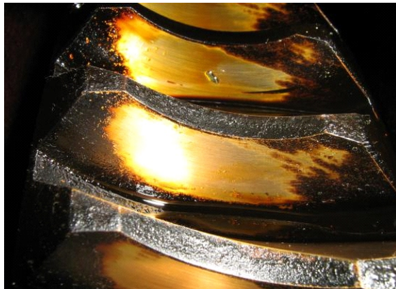
图3 接触精度较差的齿轮
