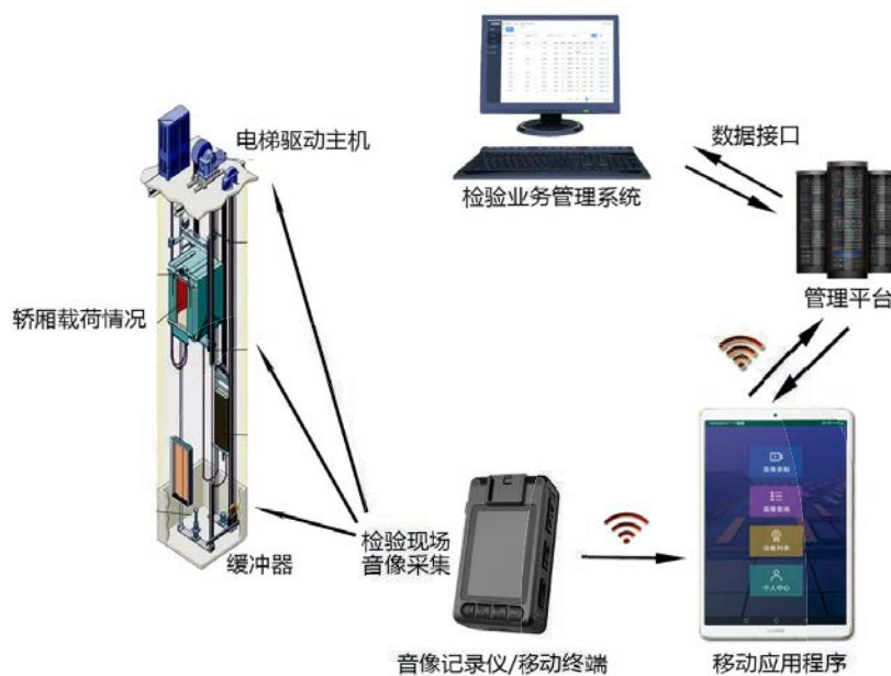
图1 电梯检验音像记录系统架构示意图
