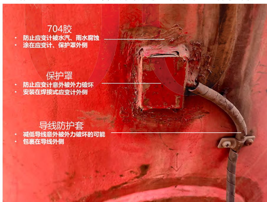
C.9 应变计导线防护图
